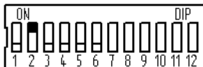
Рисунок 18.14 – Работа аппарата в режиме теста ДСВ
