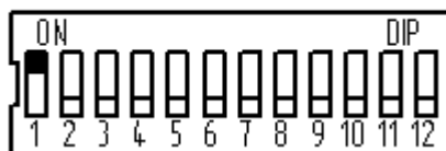
Рисунок 18.4 – Ключи для уставки выдержки времени на включение ГА – 5 минут Таб-
