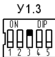
Рисунок 18.3 – Ключи для уставки диаметра патрубка ДСВ 800 мм (0,8 м)
