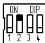
Рисунок 18.5 – Ключи для уставки выдержки времени на отключение ГА – 1 минута Таб-
