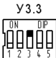
Рисунок 18.12 – Ключи для уставки длительности паузы импульсного запуска ВМП (длительность паузы 8 с)
