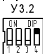
Рисунок 18.11 – Ключи для уставки длительности импульса импульсного запуска ВМП (длительность импульса 3 с)
