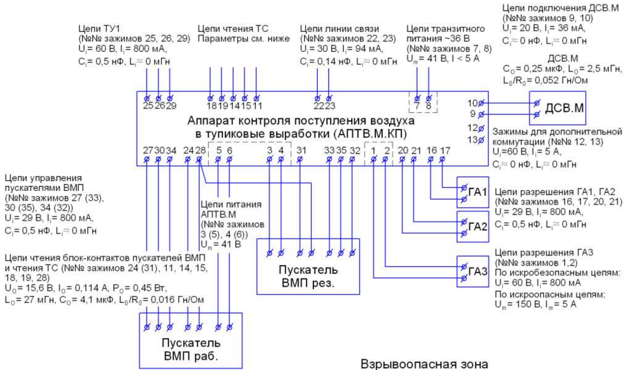
Рисунок Ж.10 – Схема подключений АПТВ.М.КП. Параметры искробезопасности
