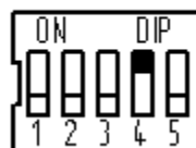
Рисунок 18.10 – Ключи для установки количества циклов импульсного запуска ВМП (запуск с пятью циклами)
