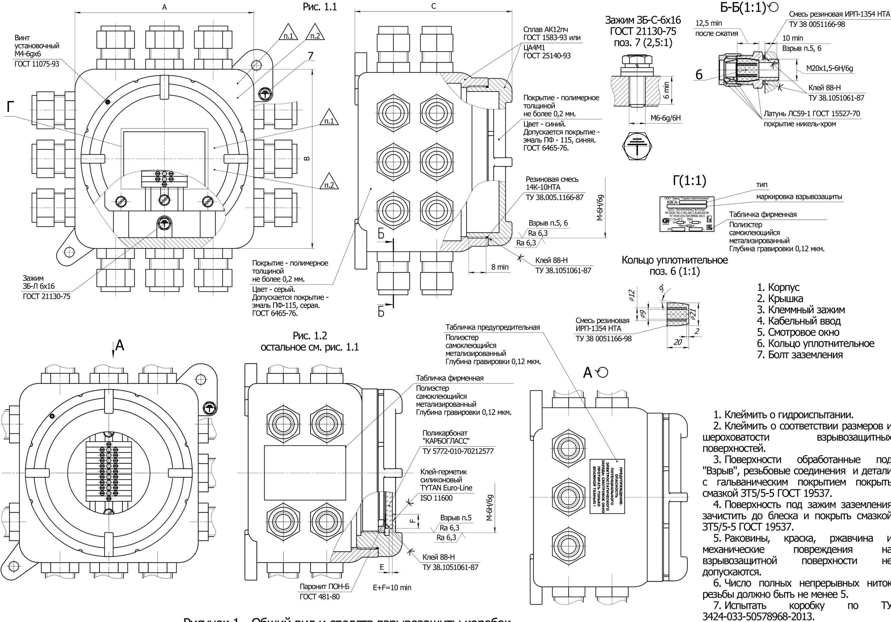
Рисунок 1 - Общий вид и средств взрывозащиты коробок
